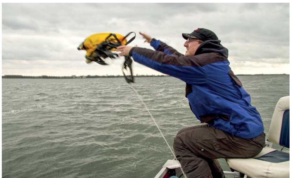
Une ancre flottante est très facile à manipuler. Il suffit de la lancer à l'eau et elle fait ensuite son office.
